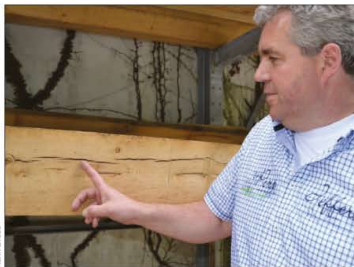
Thomas Klein zeigt Risse in Eichenbalken, die ein Erkennungszeichen für abgelagertes Holz sind, das für Fachwerksanierung eingesetzt wird.
